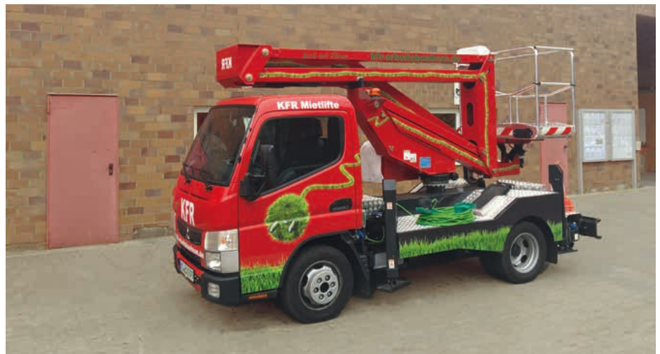
Die P 160 A kann auf Elektrobetrieb umgeschaltet werden: Laut Geschäftsführer des Arbeitsbühnenvermieters KFR Mietlifte eine attraktive Möglichkeit für Kunden, um Beschwerden zu umgehen. | Foto: Palfinger
